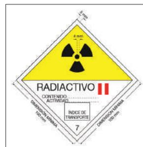
Figura 3: Etiqueta para la categoría II-AMARILLA. La anchura mínima de la línea dentro del borde que forma el rombo será de 2 mm. El color de fondo de la mitad superior de la etiqueta será amarillo y el de la mitad inferior, blanco, el trébol y los caracteres y líneas impresos serán negros y las barras que indican la categoría serán rojas.
