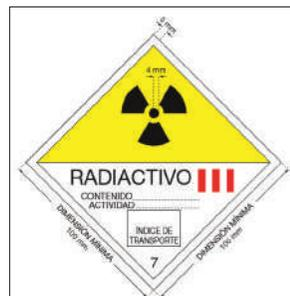
Figura 4: Etiqueta para la categoría III-AMARILLA. La anchura mínima de la línea dentro del borde que forma el rombo será de 2 mm. El color de fondo de la mitad superior de la etiqueta será amarillo y el de la mitad inferior, blanco, el trébol y los caracteres y las barras que indican la categoría serán rojas
