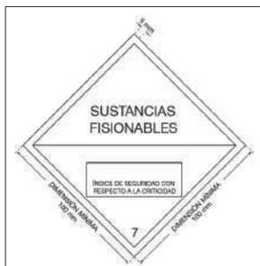
Figura 5: Etiqueta para el ISC. La anchura mínima de la línea dentro del borde que forma el rombo será de 2 mm. El color de fondo de la etiqueta será blanco y los caracteres y líneas impresos serán negros
